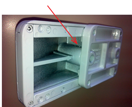
Plaats van het koperen knopje op het Thule deurslot
